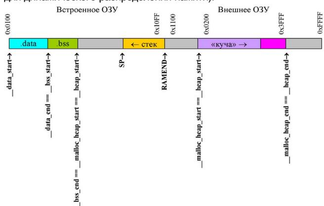
Подобное распределение с «дырами» может быть необходимо, например, в случае, когда внешнее ОЗУ физически не присутствует в определенных областях адресного пространства – ситуация вполне обычная для микроконтроллерных систем.
