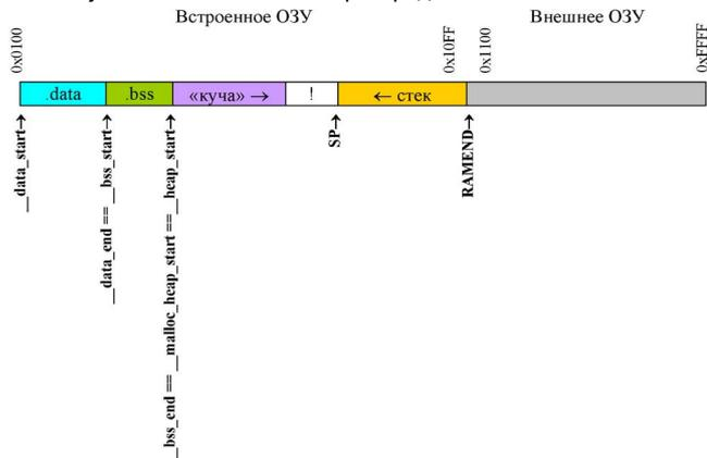
Для устройств на микроконтроллерах подобный подход непросто, т.к. нужно обеспечить минимальный размер кода, реализующего динамическое выделение памяти и контроль «границ» при обеспечении минимальной фрагментации ОЗУ, и в то же время высокое быстродействие, т.к. микроконтроллеры все еще очень медленные по сравнению с «большими» компьютерами. Программная реализация этих требований стремится к их решению, предлагая при этом некоторые средства и указывая направления для их оптимизации.
